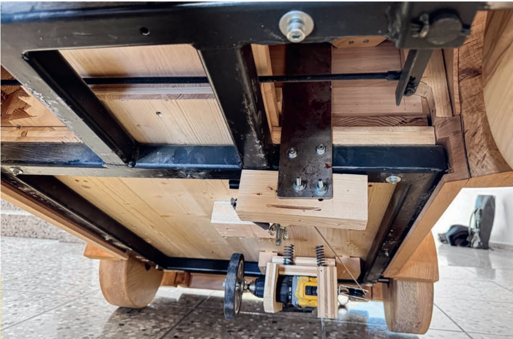
Im Unterboden befindet sich das Antriebsrad (schwarz), das mittels 18-V-Akkubohrer bewegt wird.
